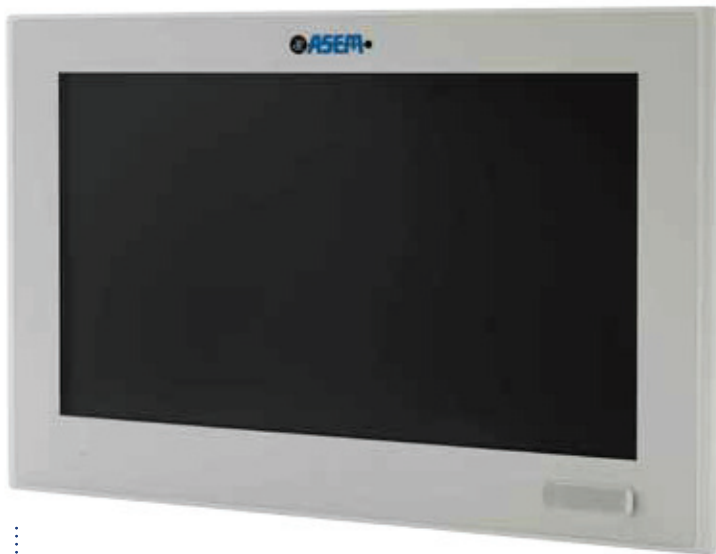
Die Prüfergebnisse werden live über einen dezentralen 12,1“-Touchmonitor MH121 von Asem angezeigt, über den auch archivierte Bilder abrufbar sind.
