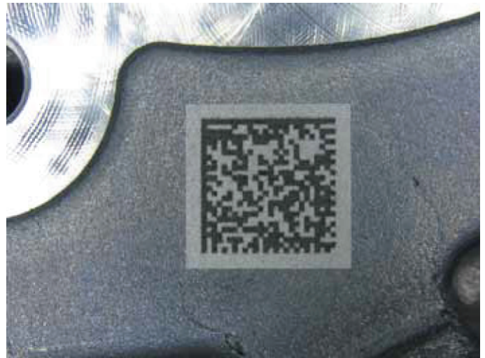
Aluminium-Druckgussteile erhalten ihre Traceability durch Datamatrix-Code. Die „gesäuberte“ Oberfläche lässt den Code noch besser hervortreten.
